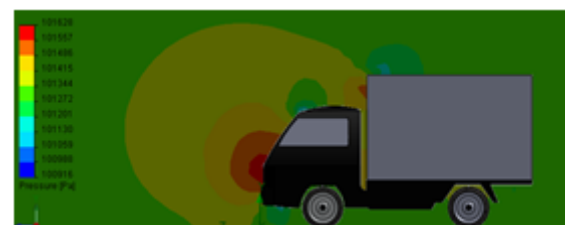
Gambar 7. Distribusi tekanan mobil box X pada 80 km/jam aliran angin yang seragam
