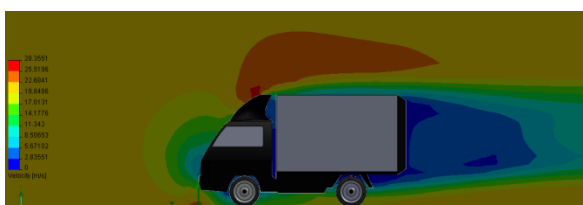
Sumber: data olahan Gambar 16. Distribusi kecepatan 80 km/jam pada mobil box Y
