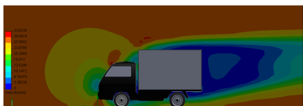
Sumber: data olahan Gambar 11. Distribusi kecepatan 100 km/jam pada mobil box X
