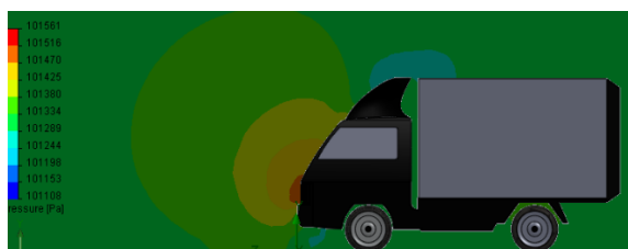
Sumber: data olahan Gambar 12. Distribusi tekanan mobil box Y pada 60 km/jam aliran angin yang seragam
