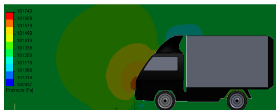
Sumber: data olahan Gambar 13. Distribusi tekanan mobil box Y pada 80 km/jam aliran angin yang seragam
