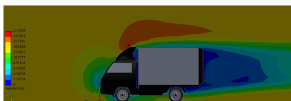
Sumber: data olahan Gambar 15. Distribusi kecepatan 60 km/jam pada mobil box Y
