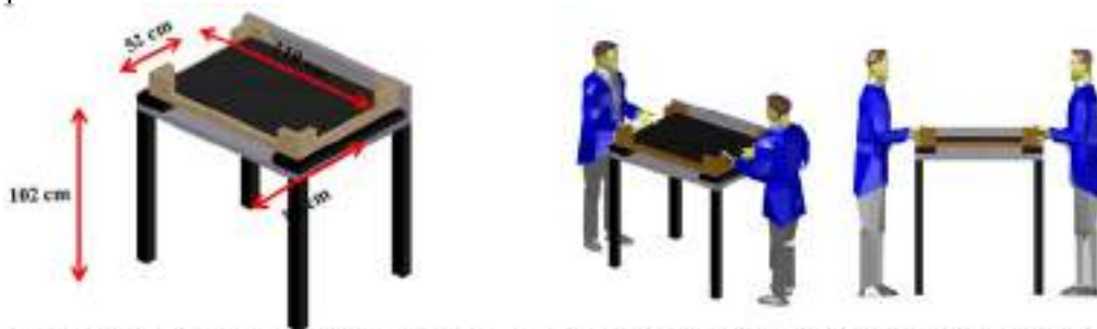
Gambar 3. Usulan perancangan meja penyimpanan kaca sun roof. Gambar 4. Cara Kerja Mengangkat Kaca Sun Roof Setelah Perbaikan
