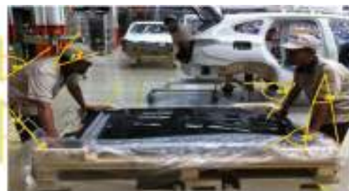
Gambar 2. Pengukuran sudut mengangkat kaca sun roof
