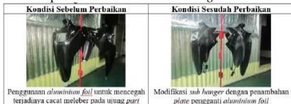
Perbaikan yang dilakukan pada cacat meleber berdampak pada hilangnya proses *Masking* pada Stasiun Kerja 2 dan hilangnya aktivitas melepas *masking* pada proses *Unloading*. Pengurangan aktivitas pada proses *Masking* dapat dilihat pada Tabel 6.
