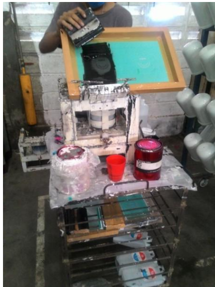
Gambar IV.16 Proses Sablon (Sumber: PT Kurnia Manunggal Sejahtera, 2016)
