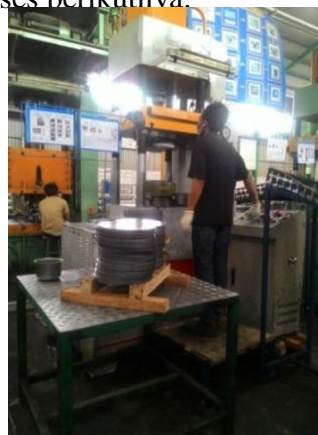
Gambar IV.6 Proses Blank (Sumber: PT Kurnia Manunggal Sejahtera, 2016)
