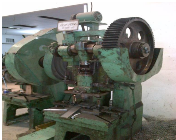
Gambar 4.3 Proses stamping dengan mesin Press 35 Ton Sumber: PT Surya Tehnika Cemerlang, 2015
