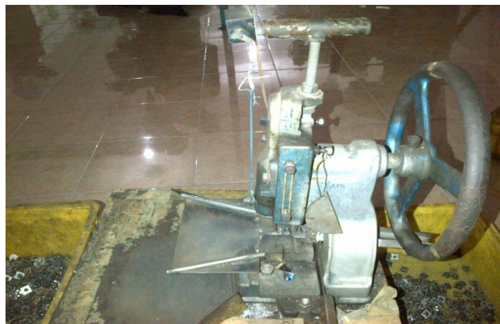
Gambar 4.7 Proses Penghalusan dengan Mesin bending Manual Sumber: PT Surya Tehnika Cemerlang, 2015
