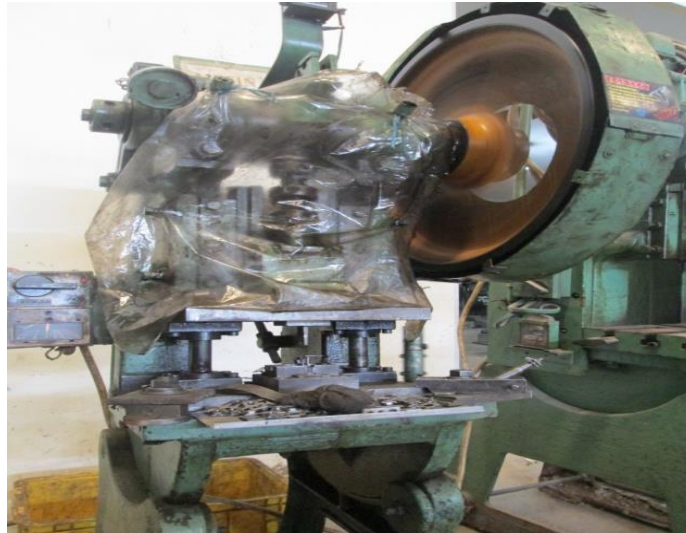
Gambar 4.6 Proses Penekukan dengan Mesin Bending 5 Ton Sumber: PT Surya Tehnika Cemerlang, 2015
