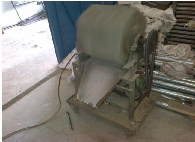
Gambar 4.4 Proses penghalusan batang dengan mesin barrel Sumber: PT Surya Tehnika Cemerlang, 2015
