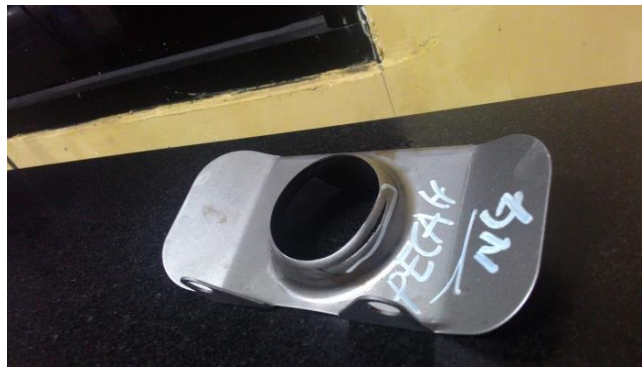
Gambar 4.17 Jenis Cacat Crack (Sumber: PT Nusa Indah Jaya Utama)
