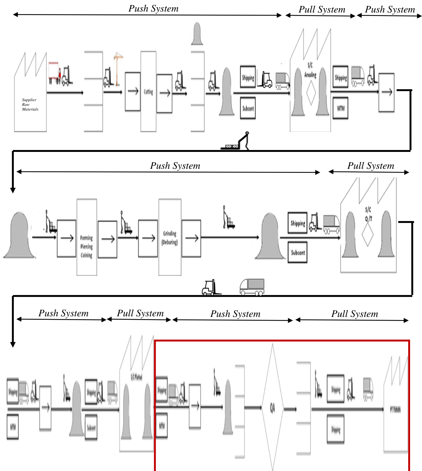
Gambar 4.9 Aliran Material dan Aliran Informasi Aktual Part Striker di PT Menara Terus Makmur dengan PIFC (Sumber: Pengolahan Data)
