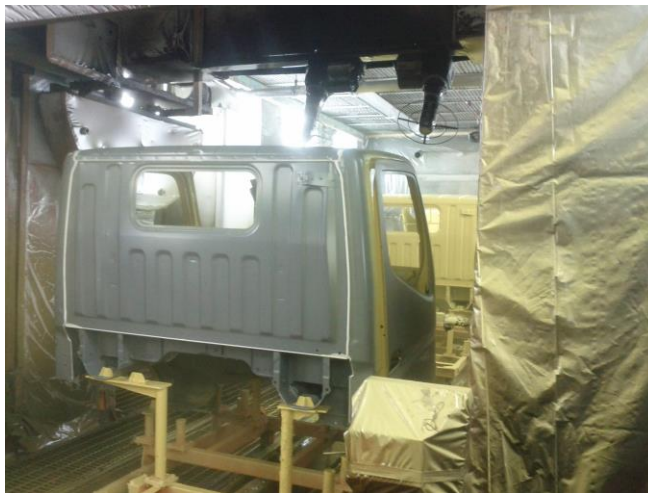
Gambar 4.10. Proses Top Coat dengan Automatic Spray Machine (Sumber : Pengumpulan Data)
