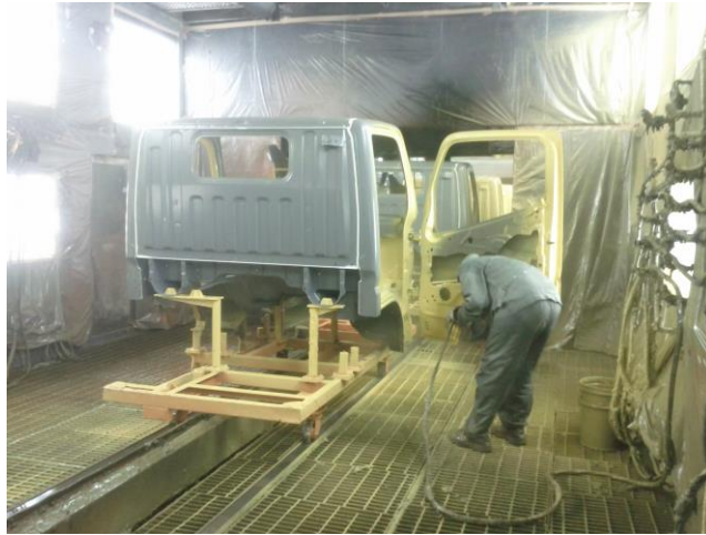
Gambar 4.9. Proses Top Coat dengan Manual Spray (Sumber : Pengumpulan Data)
