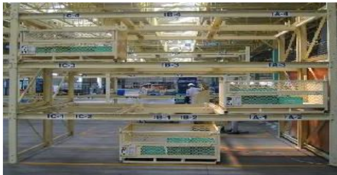
Gambar 5.3 Rak Pallet FLR (Setelah Perbaikan) (Sumber: PT TMMIN)
