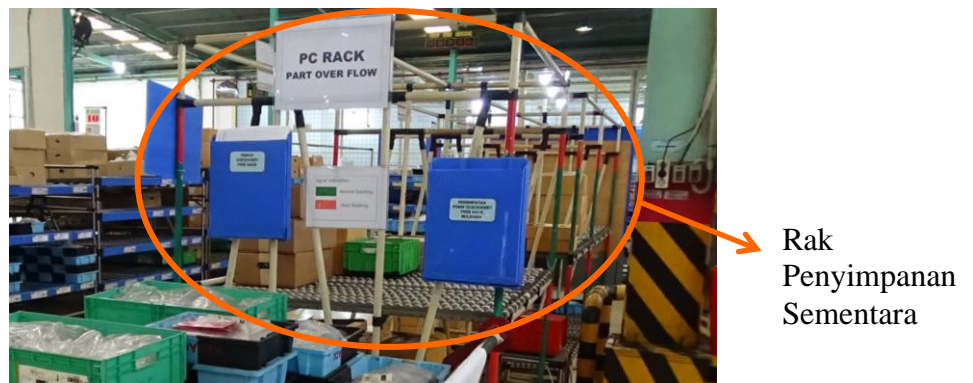
Gambar 4.10 Rak Penyimpanan Sementara (Sumber: PT TMMIN)
