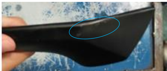
Gambar 4.6 Cacat Cat Tipis (Sumber: PT KMS)
