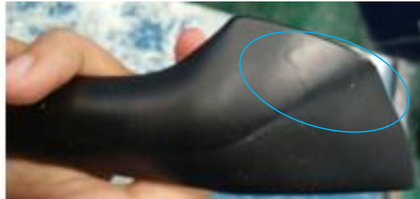
Gambar 4.7 Cacat Cat Meler (Sumber: PT KMS)
