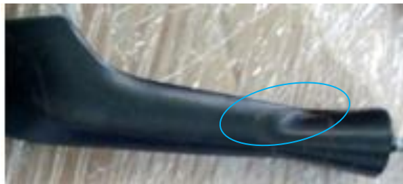
Gambar 4.8 Cacat Baret (Sumber: PT KMS)
