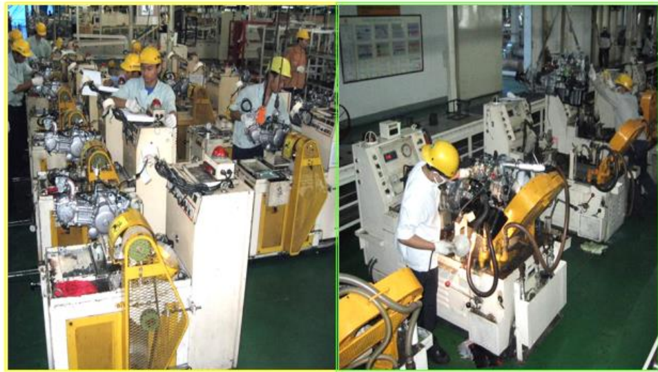
Gambar 4.9 Motoring Test (Sumber: PT SIM)
