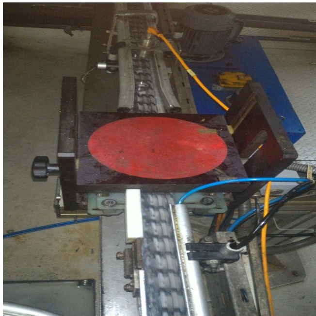
Menghilangkan Magnet ( Demagnetizing ) (Sumber : Pengumpulan Data)
