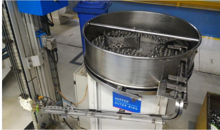
Gambar IV.9 Skema Proses Aliran Outer Ring dalam Hopper (Sumber : Pengumpulan Data)
