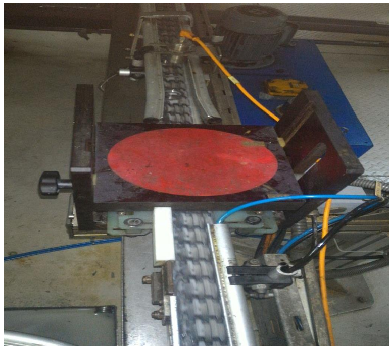
Gambar IV.11 Skema Proses Demagnetizing (Sumber : Pengumpulan Data)
