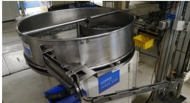
Gambar IV.17 Skema Proses Aliran Inner Ring dalam Hopper (Sumber : Pengumpulan Data)
