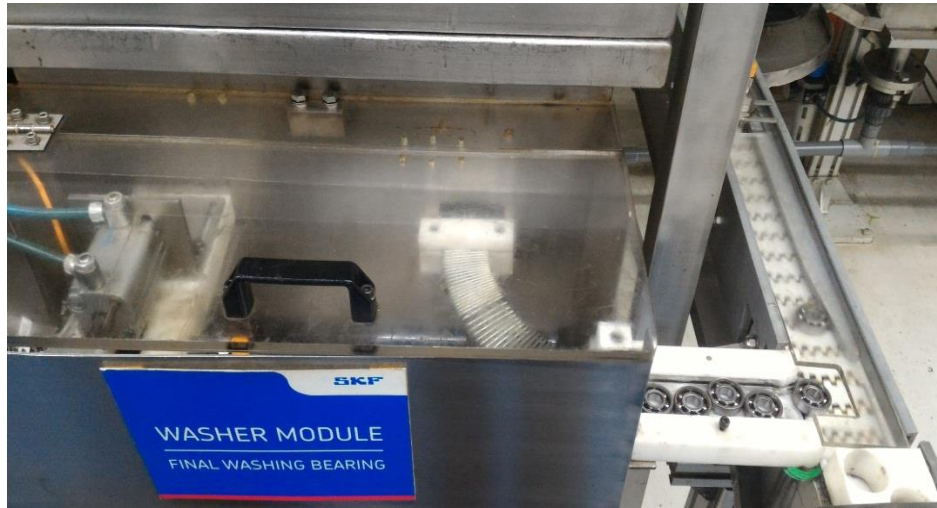
Gambar IV.37 Skema Proses Final Washer (Sumber : Pengumpulan Data)
