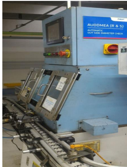
Gambar IV.15 Skema Pengecekan Toleransi dengan AUODMEA (Sumber : Pengumpulan Data)
