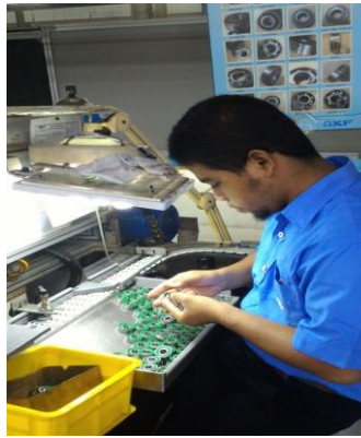
Gambar IV.41 Skema Proses Visual Inspection (Sumber : Pengumpulan Data)
