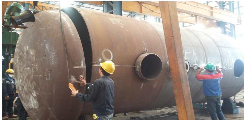
Gambar 4.10 Bagian head dan body yang akan di fit up and tack weld (Sumber: PT Gerbang Saranabaja)
