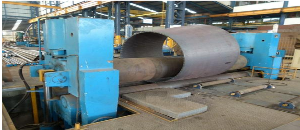
Gambar 4.9 Proses Forming (Sumber: PT Gerbang Saranabaja)
