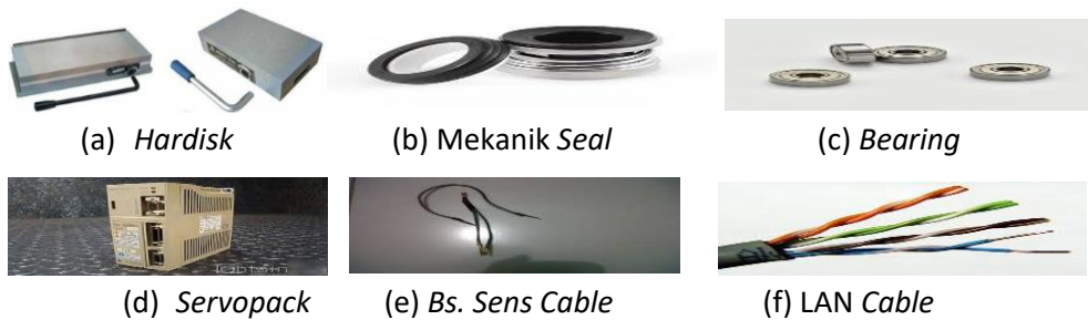
Gambar 4.4 Komponen-Komponen Kritis Mesin Wirecut
