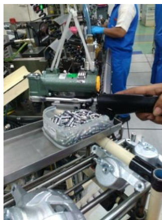
Gambar 4.5. Proses Pemasangan Screw Bleeder
