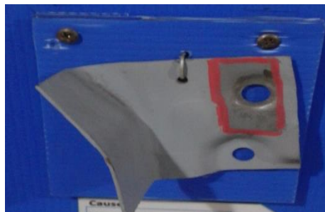
Gambar IV.13. Cacat Hole Geser Sumber: PT Mekar Armada Jaya
