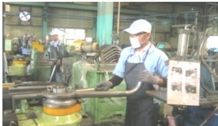
Gambar 4.9 Proses Bending Pipe (Sumber: PT Pamindo Tiga T)
