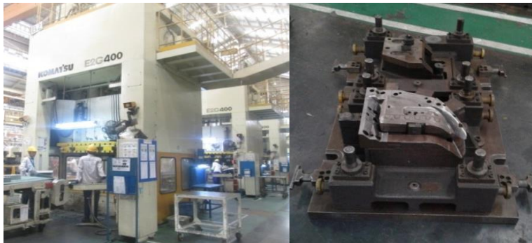
Gambar 4.6 Proses Forming dan Dies Proses Forming (Sumber: PT Mekar Armada Jaya)
