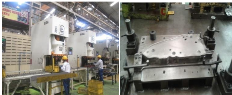
Gambar 4.5 Proses Blank dan Dies Proses Blank (Sumber: PT Mekar Armada Jaya)
