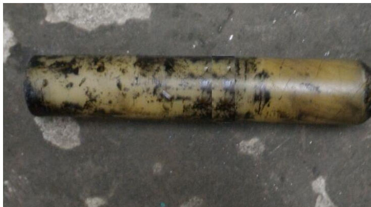
Gambar 5.3 Tutup posh comp sebelum perbaikan (Sumber: PT Indomitra Sedaya)
