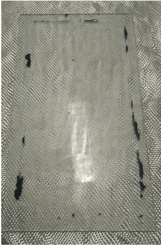
Gambar D.1 Kaca Sebagai Cetakan Komposit
