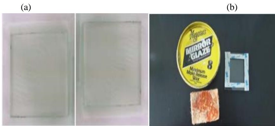
Gambar B.2 (a) Cetakan Komposit Berupa Kaca. (b) Cetakan yang Sudah Dioleskan Wax dan Di-doubel Tape Untuk Pembatas
