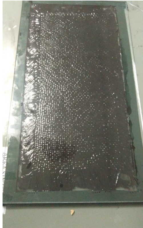
Gambar D.2 Kaca yang Sudah Diberikan Wax dan Double Tape
