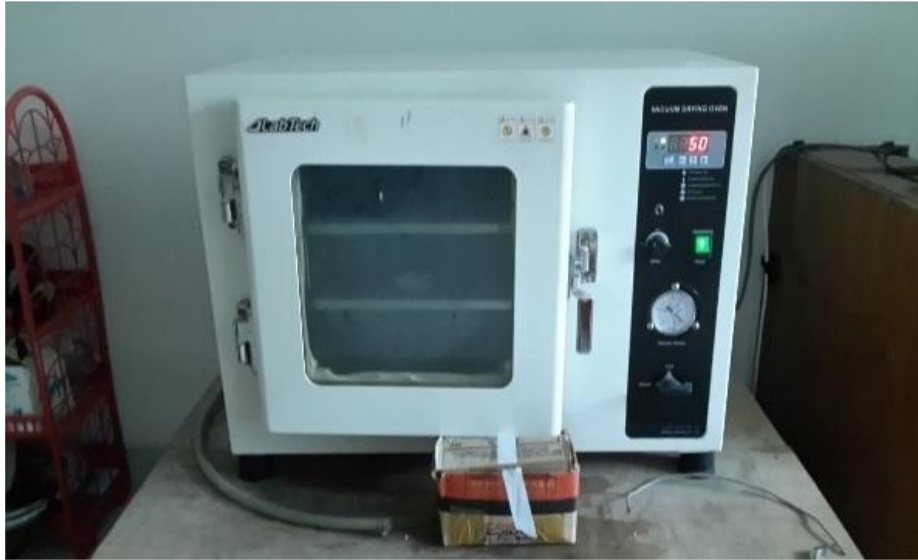
Gambar B.1 Pengeringan Carbon Black dan Clay
