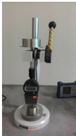
Gambar 9. Durometer Hardness Tipe Shore A Untuk Pengujian Kekerasan Karet
