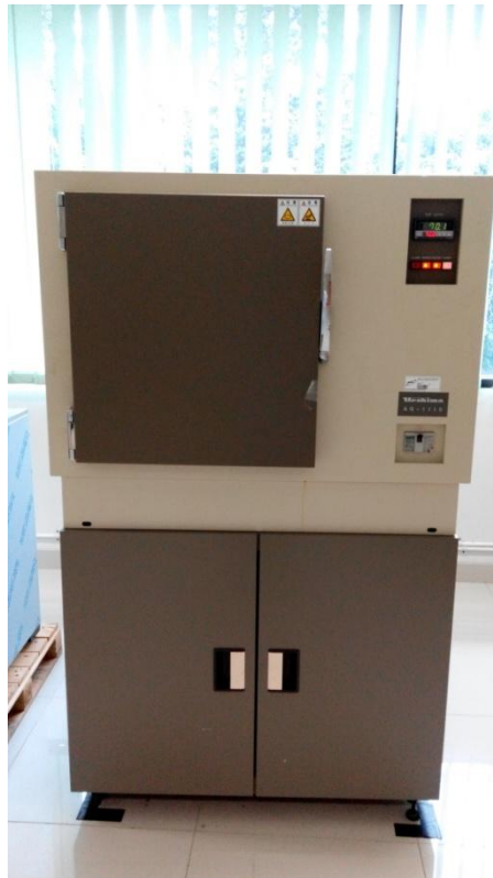
Gambar 11. Oven Aging Untuk Pengujian Pengusangan
