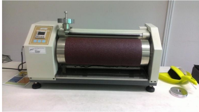
Gambar 7. Abrasion Tester DIN 53516 Untuk Pengujian Ketahanan Kikis Karet
