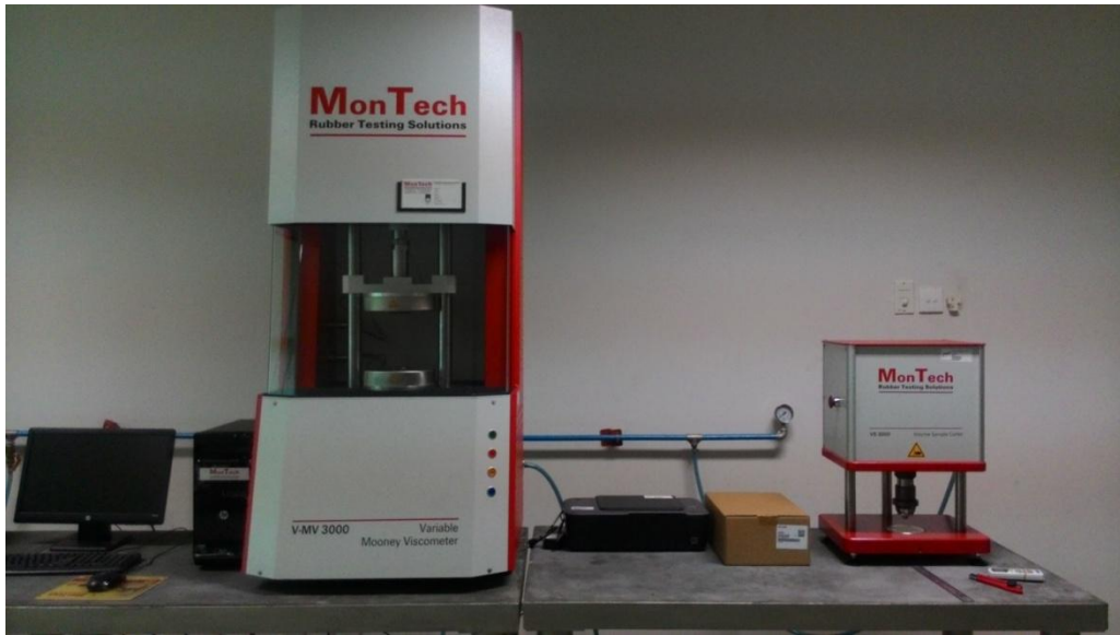
Gambar 5. Mooney Viscometer Untuk Pengujian Viskositas Karet
