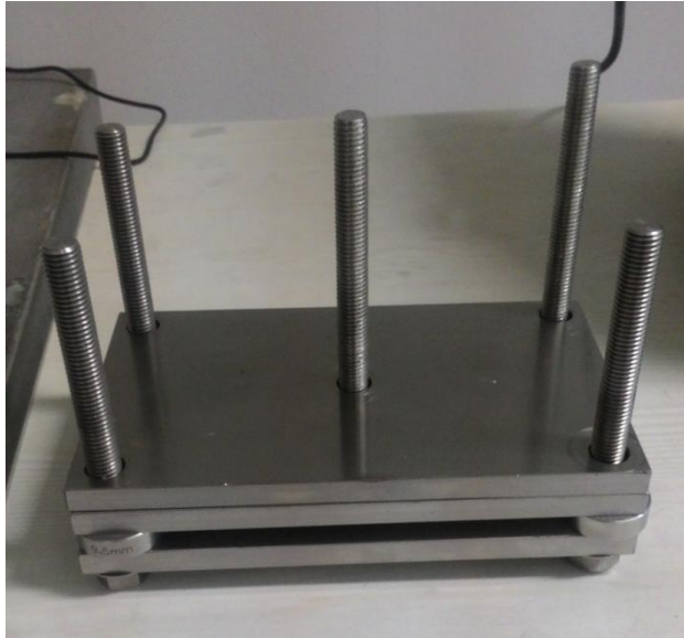
Gambar 10. Compression Set Untuk Pengujian Pemampatan Karet
