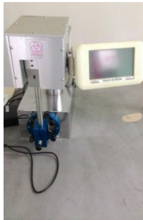
Gambar 8. Rebound Resilience Tester Untuk Pengujian Pantul Karet
