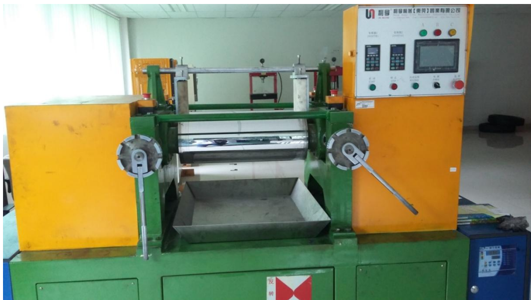
Gambar 2. Open Mill Untuk Proses Penggilingan Karet ( Milling )
