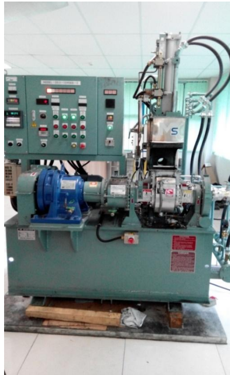
Gambar 1. Kneader Untuk Proses Pencampuran Karet ( Mixing )
