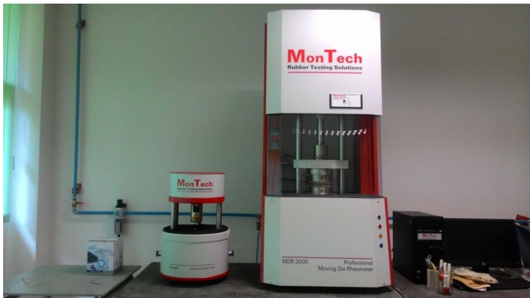
Gambar 4. Moving Die Rheometer Untuk Pengujian Kematangan Karet
