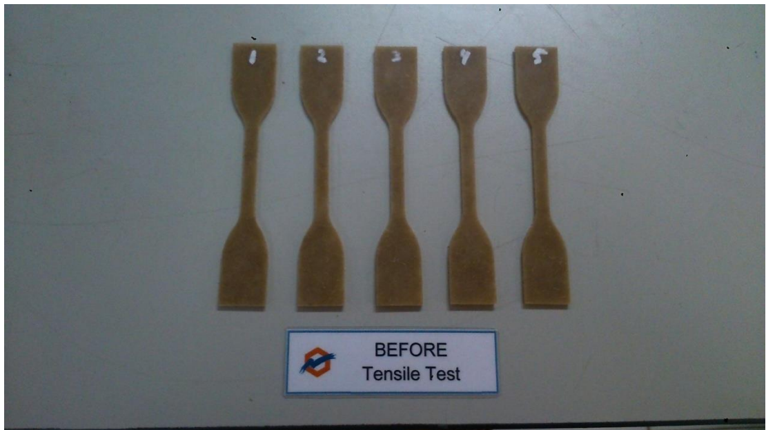
Spesimen Uji Kekuatan Tarik Sebelum Dilakukan Pengujian
