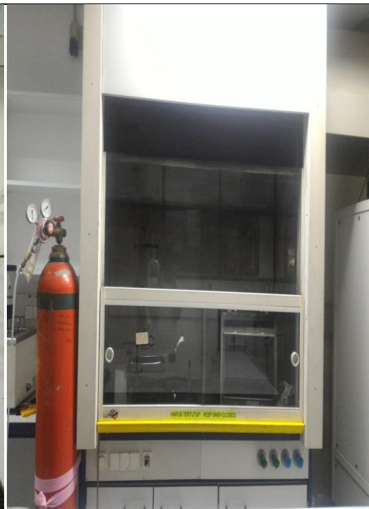
Gambar A.8 Alat Uji Flammability dengan Burning
