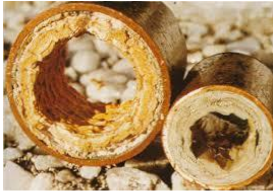
Gambar 2.4 Pengerakan Pada Pipa
