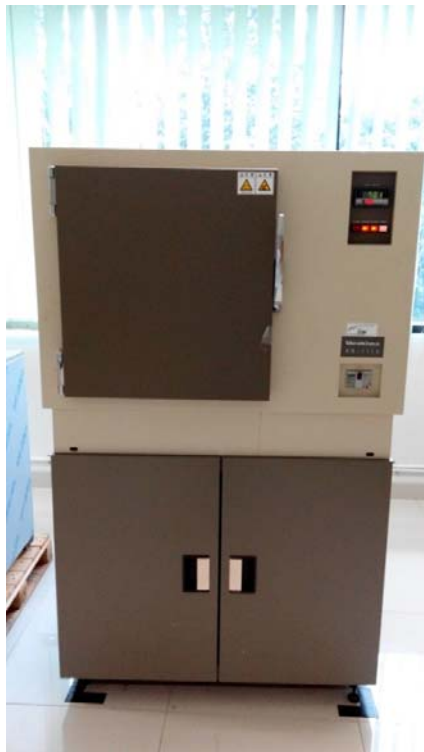
Gambar.12. Oven Aging untuk Pengujian Pengusangan
