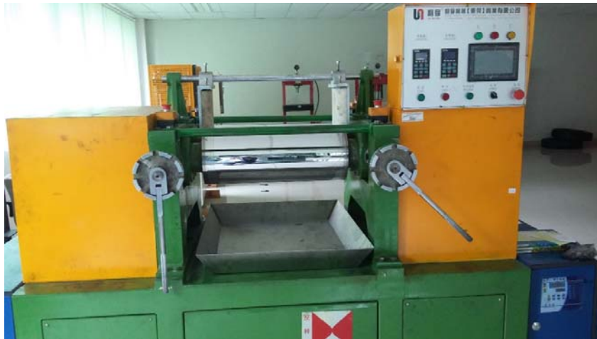
Gambar.3. Open Mill Machine untuk penggilingan
