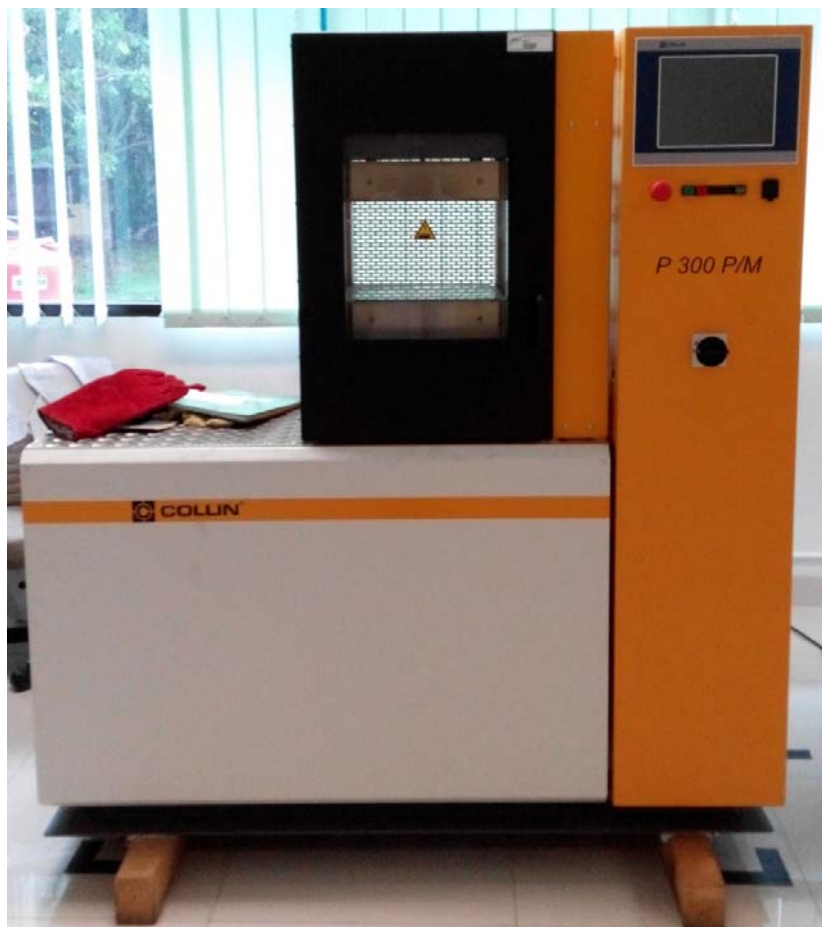
Gambar.4. Hot Press 300P/M untuk proses pematangan karet
