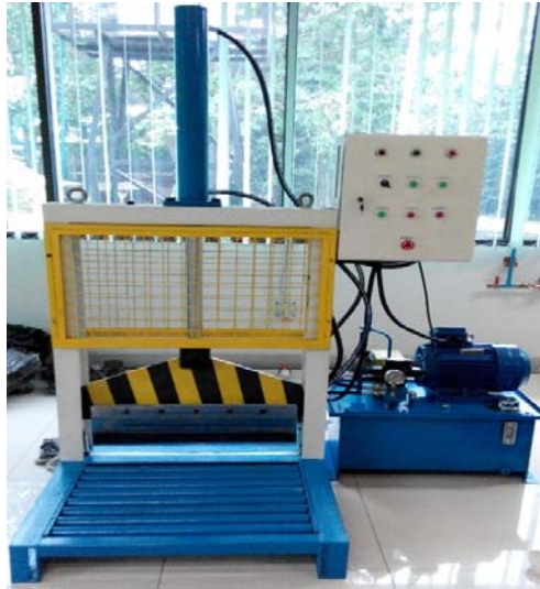
Gambar.1. Rubber Cutting Machine untuk memotong karet
