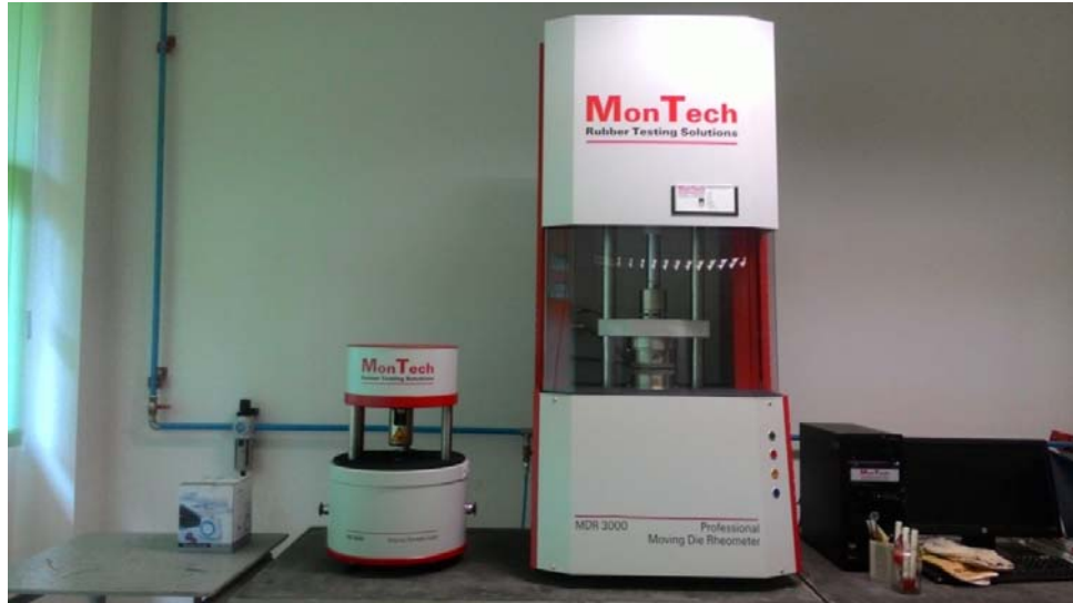
Gambar.5. MonTech Moving Die Rheometer MDR-3000 untuk pengujian waktu matang kompon karet
