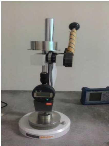
Gambar.10. Durometer Hardness Tipe Mitutoyo Shore A untuk Pengujian Kekerasan
