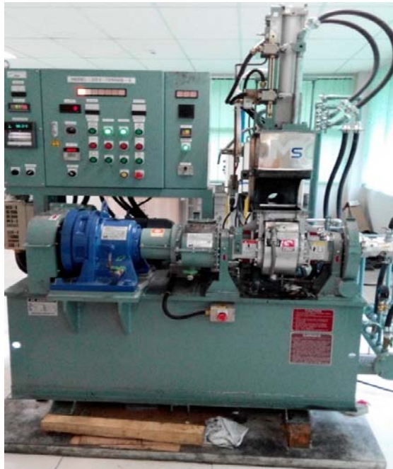
Gambar.2. Kneader machine untuk proses pencampuran
