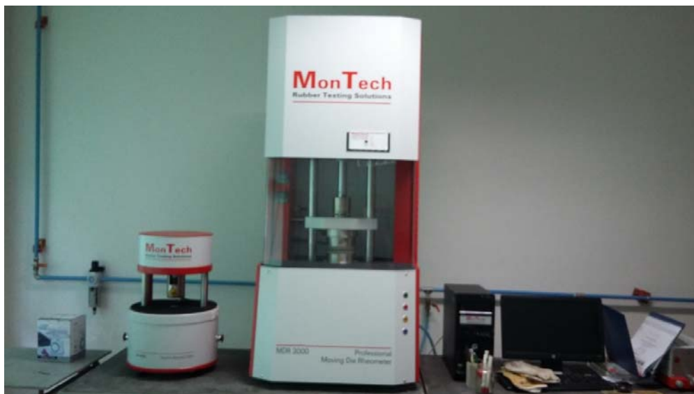
Gambar.6. MonTech V-MV 3000 Variable Mooney Viscometer untuk pengujian viskositas kompon karet
