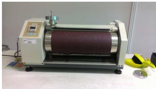
Gambar.8. DIN Abrasion Tester AT150 untuk Pengujian Ketahanan Kikis
