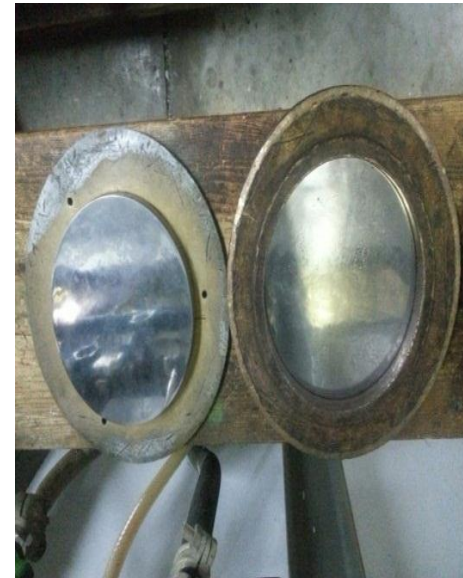
Gambar 4. Hot Press dan Mold yang digunakan
