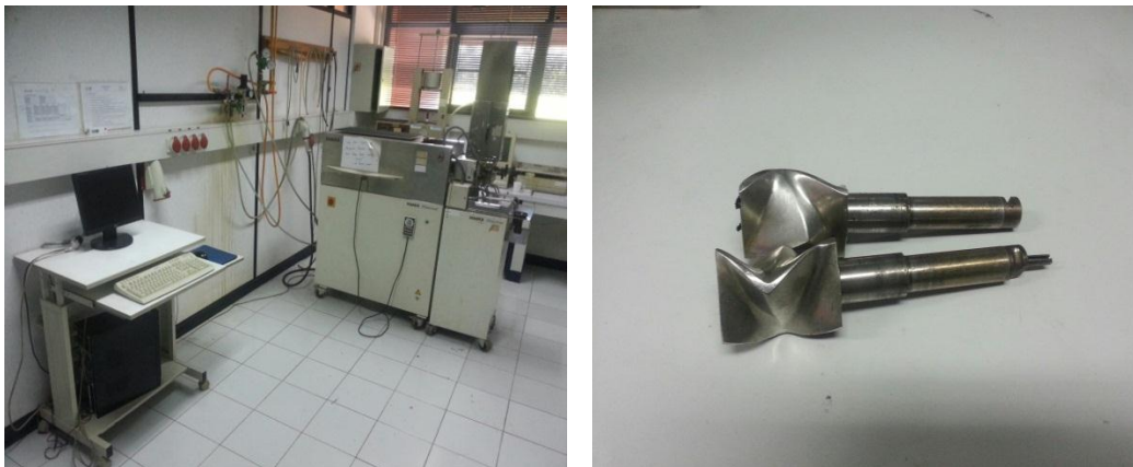
Gambar 2. Internal Mixer dan Banbury Screw yang digunakan
