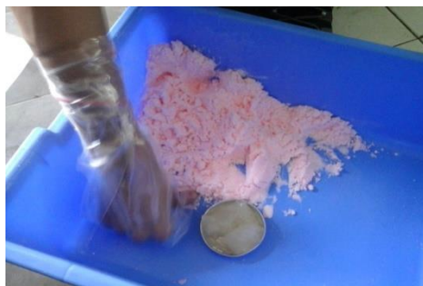
Gambar B.4 Pencampuran Bubuk Pupuk Urea dengan Polimer Alam
