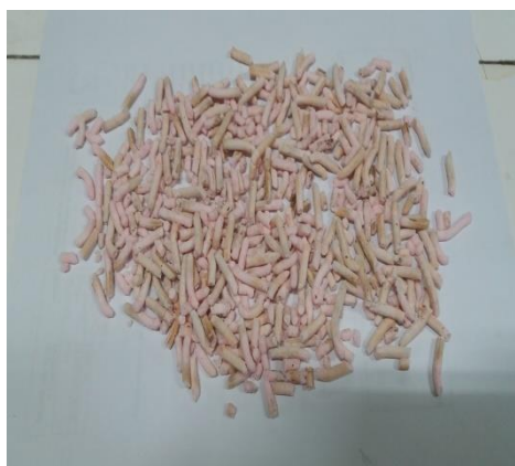
Gambar B.7 Hasil Pupuk Pellet Urea Setelah Dikeringkan Menggunakan Oven
