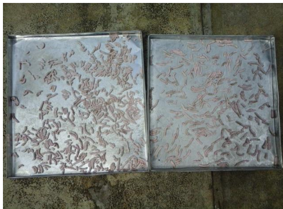
Gambar B.6 Hasil Pupuk Pellet Urea Setelah di Cetak Menggunakan Alat Pelletizer dengan Kecepatan Lambat
