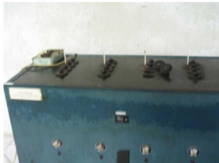
Gambar 3.11 Alat Uji Pour Point
