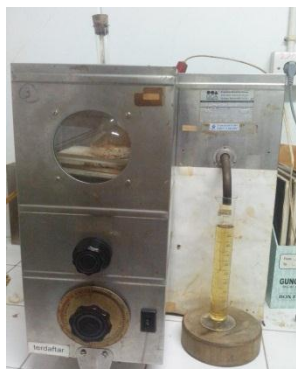
Gambar 3.14 Alat Uji Distilasi
