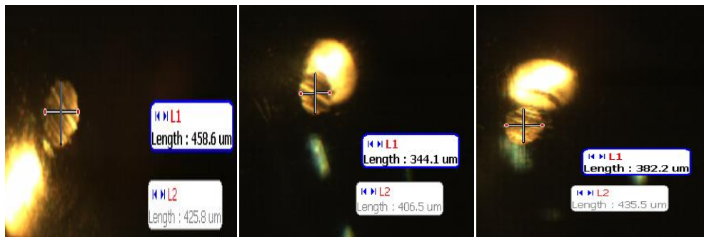
Gambar IV.7 Hasil scar diameter pada grease
