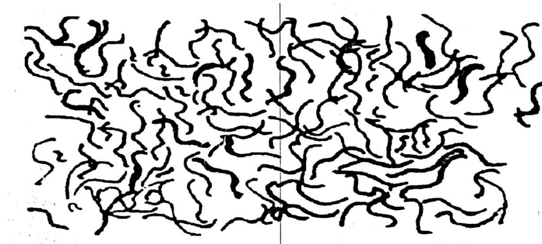
Gambar II.7 Penggambaran serat pengental sabun dalam grease [10]
