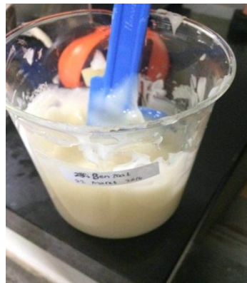
Gambar B.5 Proses Pendiaman Gemuk Litium Kompleks Pada Temperatur Kamar
