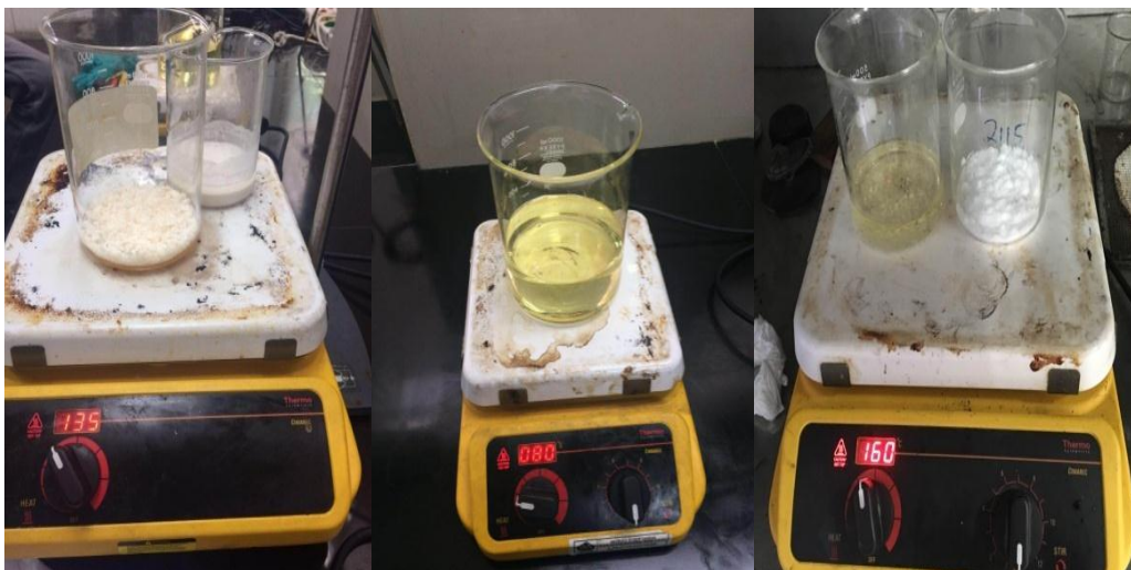
Gambar B.2 Proses Pemanasan Bahan Baku
