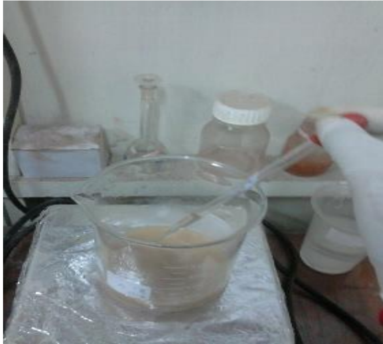
Gambar 4.5. Pengendapan dengan NH 4 OH
