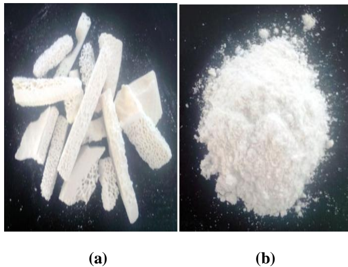
Gambar IV.1. Tulang Sapi Mentah Sebelum Perlakuan dengan Proses Alkalin Hidrotermal (a), dan Ekstrak Hidroksiapatit Setelah Perlakuan (b)
