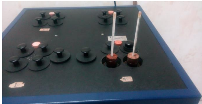
Gambar 3.7 Uji Titik Tuang
