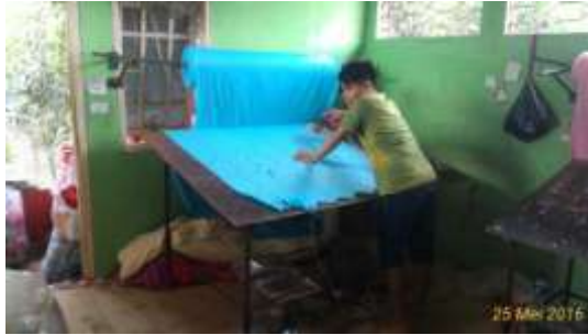
Gambar 4.12: Pemotongan Pola dengan Mal Asbes
