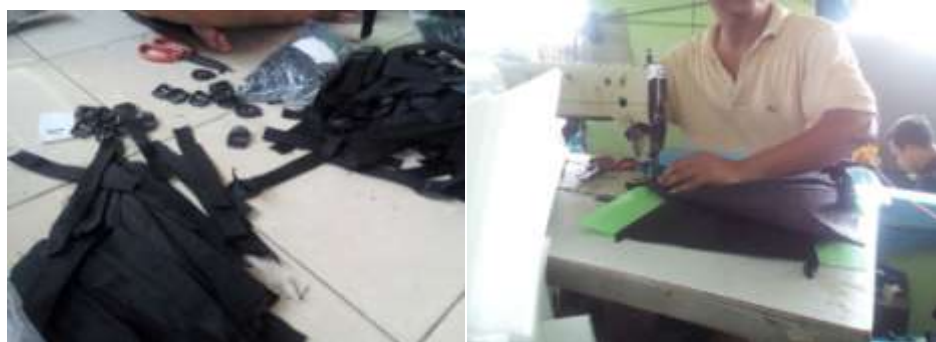
Gambar 4.11 Proses penjahitan dan pemasangan ring
