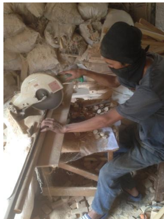
Gambar 4.9. Proses Pemotongan Kayu Sesuai Pola
