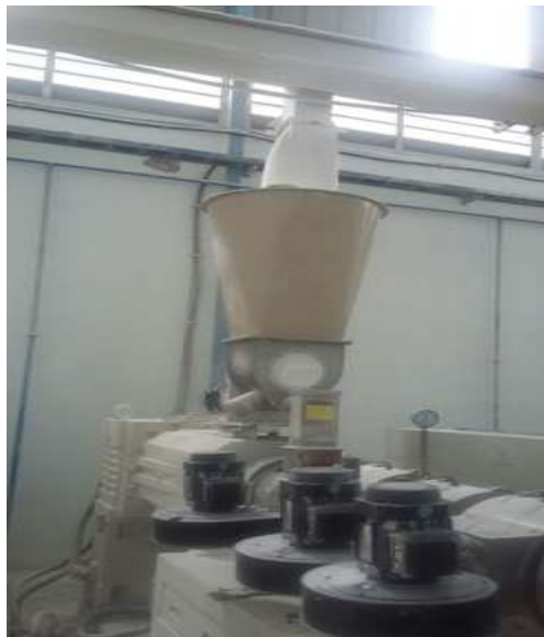
Gambar 4.9 Mesin yang di atas Sentra Veader, di bawahnya tabung over dan bahan baku akan turun ke Mesin exrhuder 2
