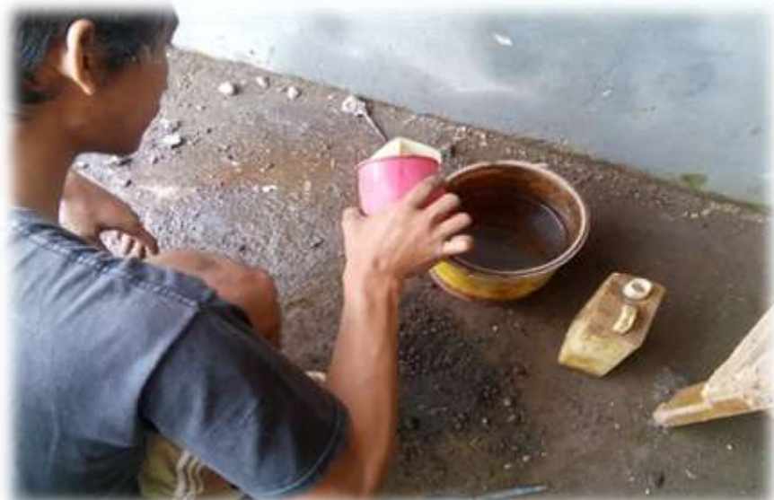
Gambar 4.11 Perendaman Kujang dengan Air Keras
