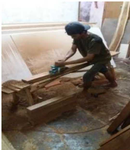
Gambar 4. 18 Proses Penyerutan Kayu
