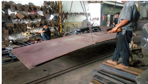
Gambar 4.4 Tahap Penurunan Plat Baja / Bahan Baku Dasar
