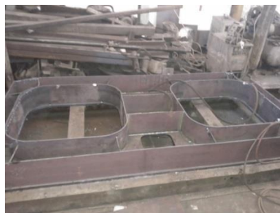
Gambar 4.14 Proses Setting / Perakitan Rangka Dasar
