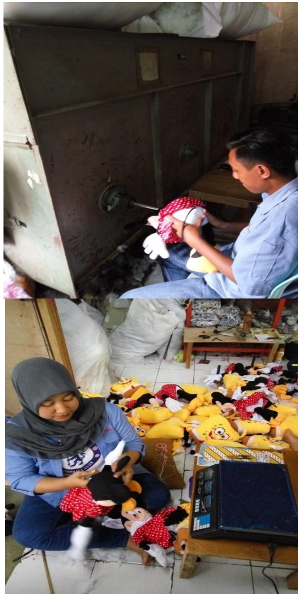
Gambar 4.11 Proses Pengisian Kapas dan Penimbangan
