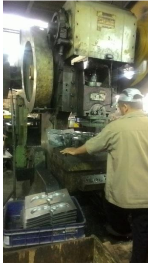
Gambar 4.11. Proses Pencetakan Plat
