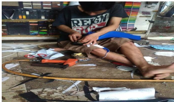
Gambar 4. 11 Pemasangan Sarung Kulit Jok Dengan Pengeleman
