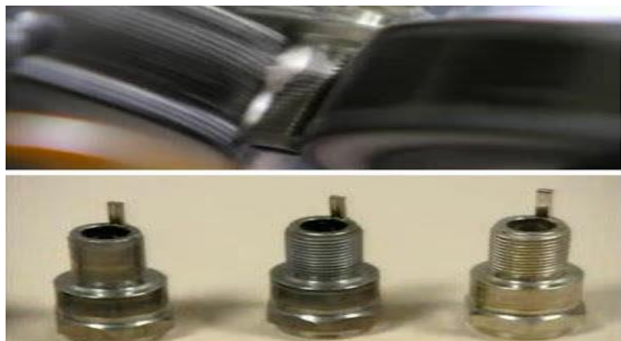
Gambar IV. 7 Proses Pembuatan Drat pada kepala busi
