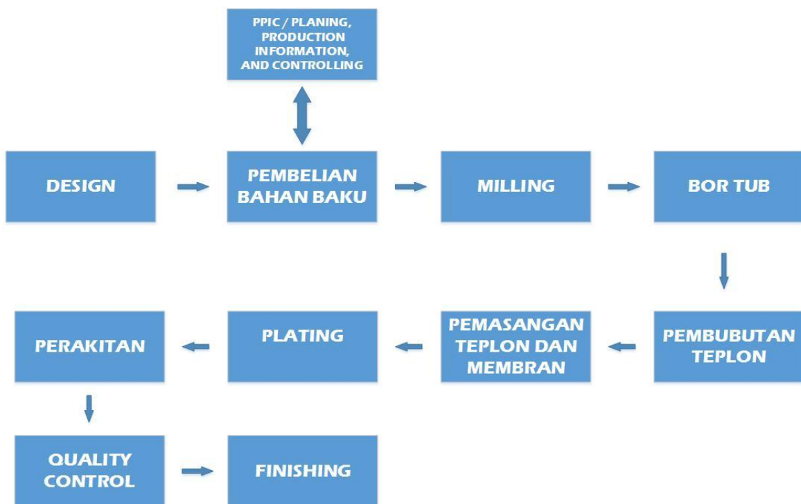
Gambar 4. 6 Alur Produksi Spray Head
