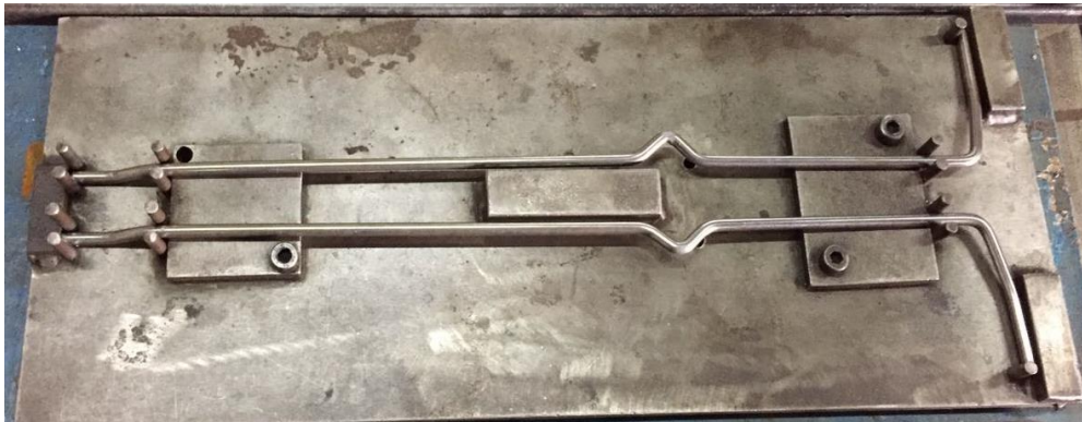
Gambar 16. Pengecekan Trim Wire A pada JIG
