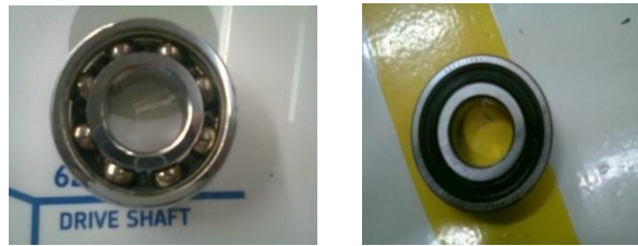
Gambar 4.5 Contoh jenis tipe Bearing 6204
