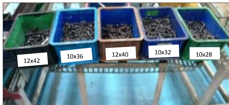
Gambar 5.5. Penempatan Box Rivet (Setelah Perbaikan) (Sumber: PT Gemala Kempa Daya)
