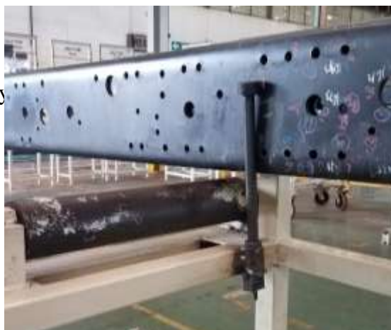
Gambar 5.13 Perbaikan Pada Meja Jig Roller Penambahan Ring Bracket (Sumber: Hasil Perbaikan)
