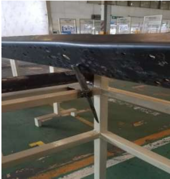
Gambar 5.12 Posisi Side Rail Sebelum Ada Ring Bracket (Sumber: Hasil Pengerjaan Sebelum Perbaikan)
