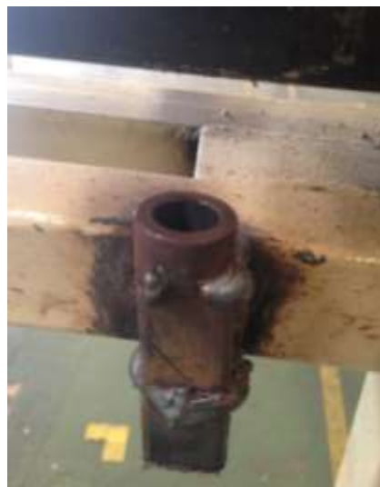
Gambar 5.13 Perbaikan Pada Meja Jig Roller Penambahan Ring Bracket (Sumber: Hasil Perbaikan)
