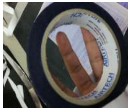
Gambar 4.17 Flash Breaker (Sumber: PT Dirgantara Indonesia)
